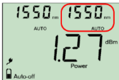
Рис. 31. Длины волн на источнике (слева) и измерителе (справа)
