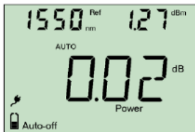
Рис. 32. Отображение опорной мощности в правом верхнем углу (в дБм) и текущих показания потерь по центру
