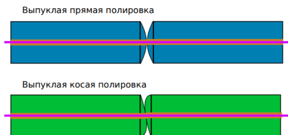
Рис. 26. Типы полировки оптических наконечников
